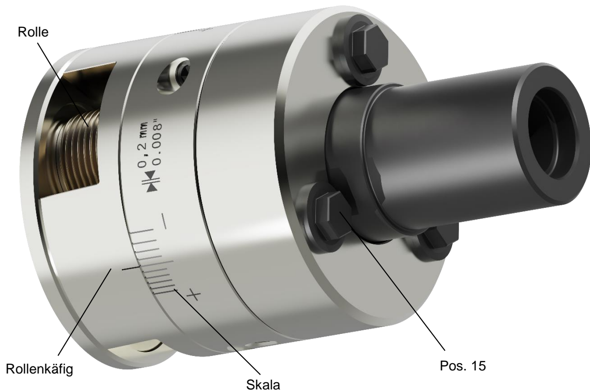
Abbildung 12: Einstellskala auf dem Gehäuse des Axial-Rollsystem
